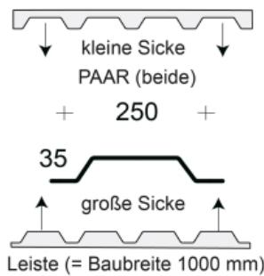
Profilfüller-Leiste für das Trapezblech Profil 33-250
