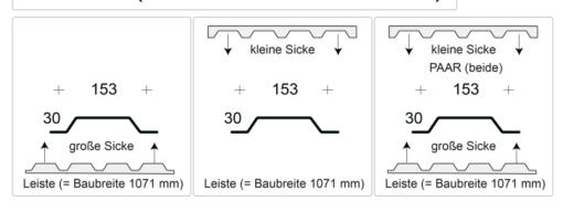
Profilfüller-Leiste für das Trapezblech Profil 30-153
