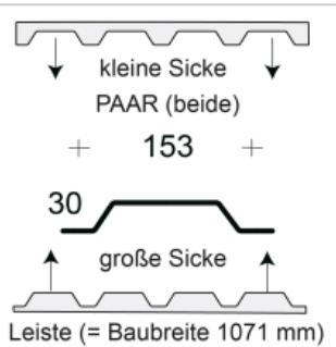
Profilfüller-Leiste für das Trapezblech Profil 30-153
