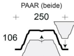
Profilfüller-Stücke für das Trapezblech Profil 106-250
