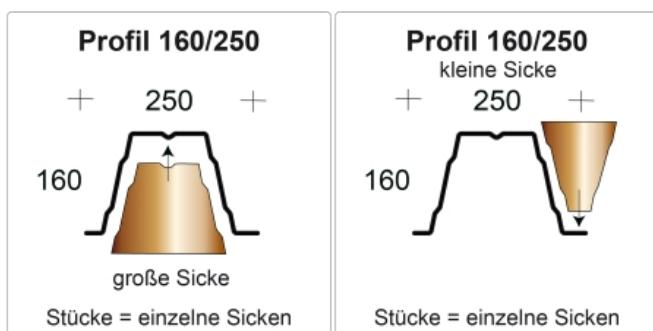
Profilfüller-Stücke für das Trapezblech Profil 160/250
