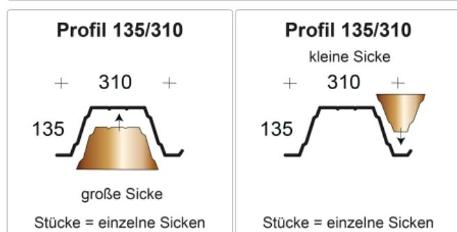
Profilfüller-Stücke für das Trapezblech Profil 135/310
