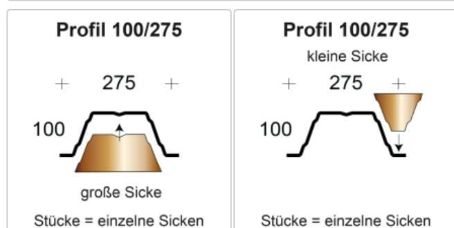
Profilfüller-Stücke für das Trapezblech Profil 100/275
