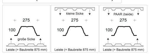
Profilfüller-Leiste für das Trapezblech Profil 100-275
