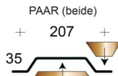
Profilfüller-Stücke für das Trapezblech Profil 35/207
