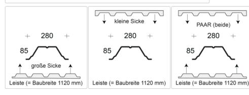
Profilfüller-Leiste für das Trapezblech Profil 85-280
