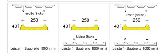
Profilfüller-Leiste für für Isopan Isocop Profilgeomterie der Deckschale: 40/250
