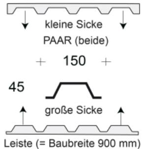
Profilfüller-Leiste für das Trapezblech Profil 45-150
