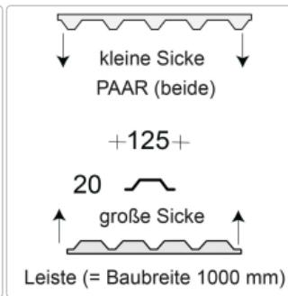
Profilfüller-Leiste für das Trapezblech Profil 20-125
