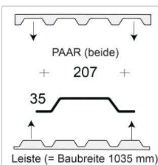
Profilfüller-Leiste für das Trapezblech Profil 35-207 **selbstklebend**
