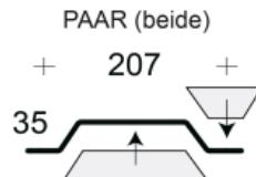
Profilfüller-Stücke für das Trapezblech Profil 35-207
