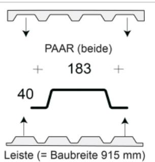
Profilfüller-Leiste für das Trapezblech Profil 40-183
