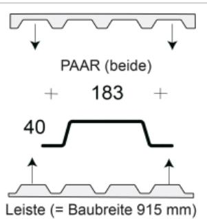
Profilfüller-Leiste für das Trapezblech Profil 40-183
