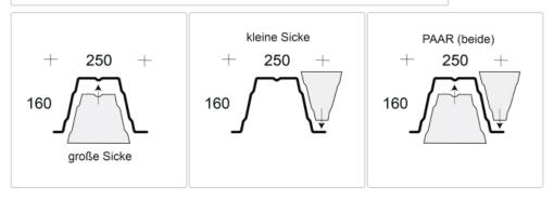
Profilfüller-Stücke für das Trapezblech Profil 160/250
