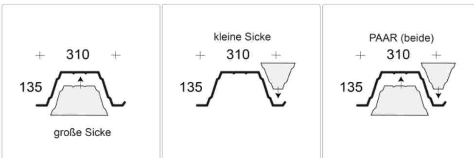
Profilfüller-Stücke für das Trapezblech Profil 135/310
