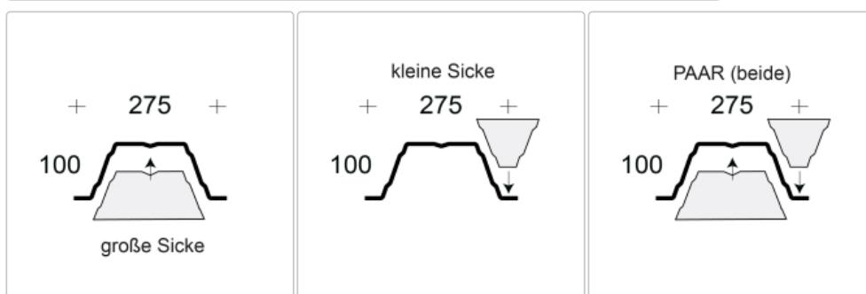
Profilfüller-Stücke für das Trapezblech Profil 100-275
