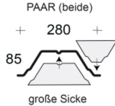
Profilfüller-Stücke für das Trapezblech Profil 85-280
