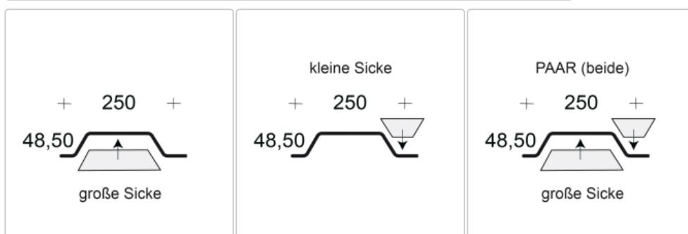
Profilfüller-Leiste für das Trapezblech Profil 50-250
