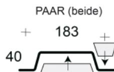
Profilfüller-Stücke für das Trapezblech Profil 40-183
