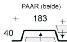
Profilfüller-Stücke für das Trapezblech Profil 40-183
