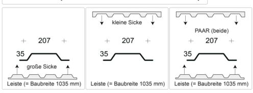
Profilfüller-Leiste für das Trapezblech Profil 35-207
